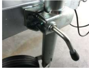
Roue jockey avec collier démontable / modèle non freinée
