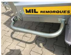
Protections latérales avec support signalisation
