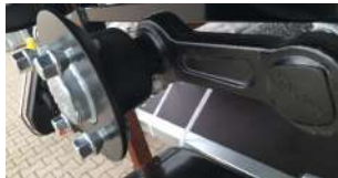
Essieu non freiné 750 kg : Moyeu surdimensionné et bras en acier forgé
