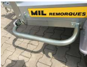
Protections latérales avec support signalisation
