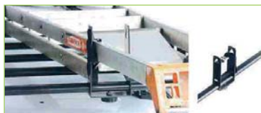
6590A Bloque-échelle Système de calage pour transporter échelles et objets lourds. Fixation rapide sur barres rectangulaires et ovales. 2 stop-échelles avec des lumières pour le passage des sangles. En acier haute résistance, ép. 4 mm. Section barres maxi rectangulaires 30 x 30 mm et ovales 38 x 30 mm. 2 sangles 2,5 m haute résistance incluses.
