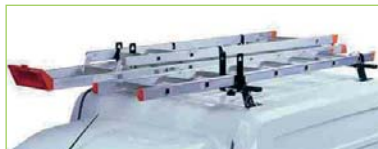
6590A Bloque-échelle Système de calage pour transporter échelles et objets lourds. Fixation rapide sur barres rectangulaires et ovales. 2 stop-échelles avec des lumières pour le passage des sangles. En acier haute résistance, ép. 4 mm. Section barres maxi rectangulaires 30 x 30 mm et ovales 38 x 30 mm. 2 sangles 2,5 m haute résistance incluses.
