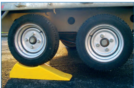
1 - Changer une roue crevée sans décharger
